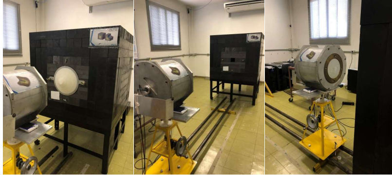
Figura 1: Medição com o LC nas instalações da unidade padrão de fluxo de nêutrons térmicos, FT2, do LNMRI/IRD
