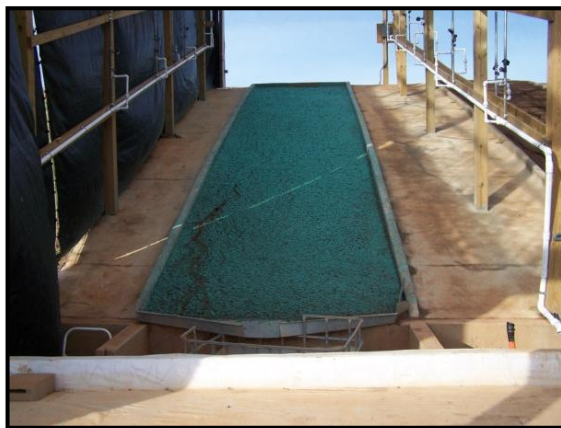
(d) Testing of a HECP
