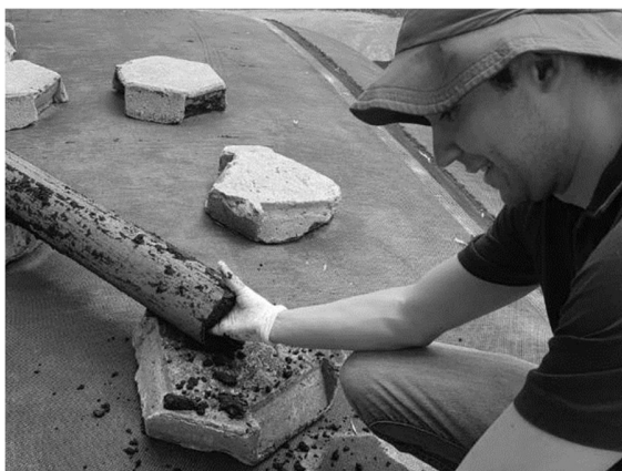
a) Recuperación del lodo extraído del interior del geocontenedor con un tubo de 4" hincado a presión
