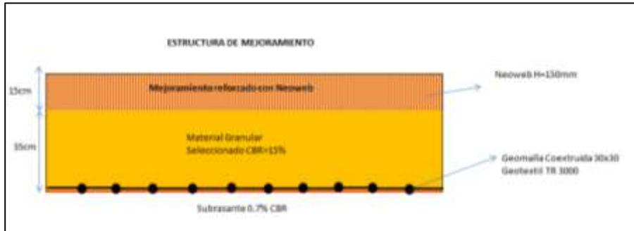
Figura 9. Estructura propuesta para la estabilización.
