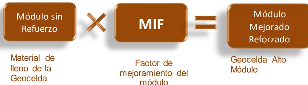
El MIF afecta a la zona totalmente confinada por la Geocelda, es decir a la capa de material correspondiente a la altura de la misma, y 2cm por encima y por debajo de los límites de la Geocelda por el efecto de trabazón de agregados en el confinamiento. Por tanto, en el diseño el módulo afectado corresponde a dicha zona, tal como se observa en la siguiente gráfica.
