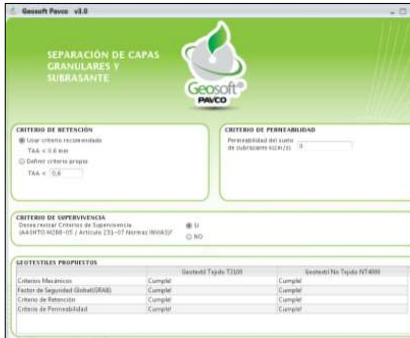
Figura 7. Resultados del Geotextil de Separación
